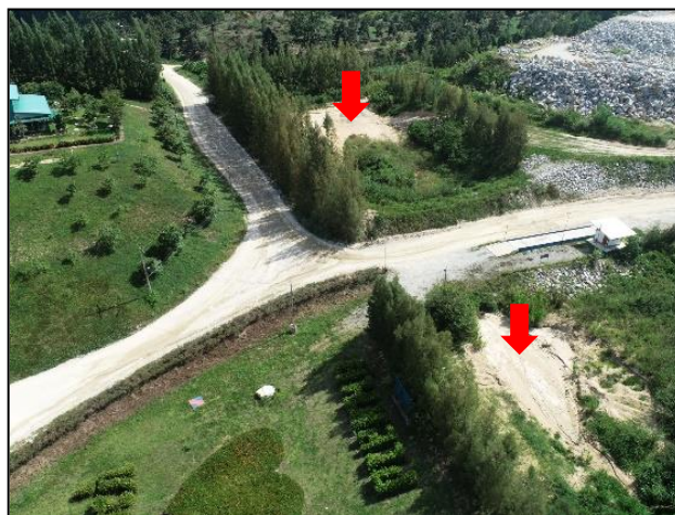
รูปที่ 1.8 บ่อดักตะกอน ขนาดพื้นที่ 1.35 ไร่ ลึก 3 เมตร และ บ่อดักตะกอน ขนาดพื้นที่ 1.5 ไร่ ลึก 3 เมตร
