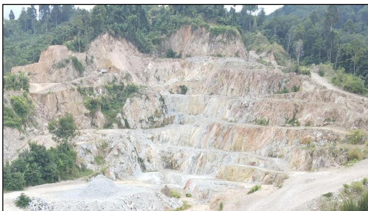
รูปที่ 1.27 โครงการออกแบบหน้าเหมืองให้มีชั้นบันไดให้ปลอดภัยเสมอ
